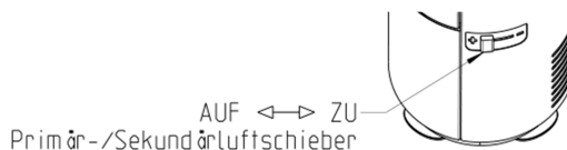
Fig. 4: régler l'arrivée d'air
