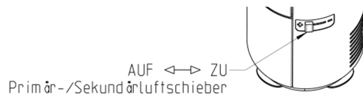
Fig. 4: Regolazione della levetta dell'aria
